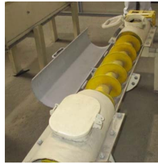
スクリーコンベアの内部 構造
